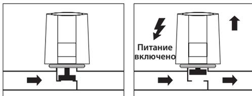
Функциональный индикатор для версий НЗ выдвигается на высоту от 0 мм до 5–6 мм при открытии привода.
